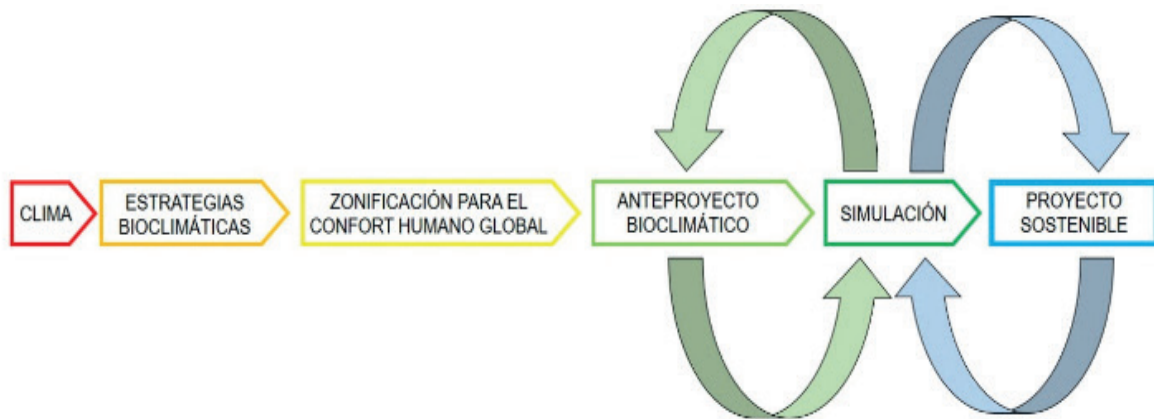
Figura 1. Pasos en el diseño de un edificio cero de emisiones de carbono. Gráfico del autor.
