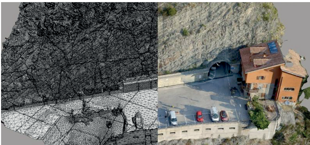
Figura 3. Modelo digital a partir de procesamiento de imágenes capturadas por un dron. Bentley.
