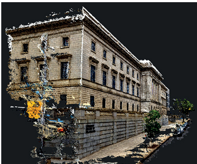
Figura 9. Modelo 3D para análisis a partir de fotografías. Autodesk Recap.
